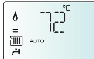
Funcția AUTO permite adaptarea funcționării cazanului la condițiile ambientale externe și la tipul de instalație care există.
