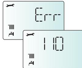
**Защитное отключение из-за низкого давления воды**
