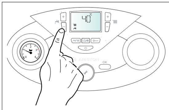
**Регулирование температуры воды в контуре ГВС****CLAS PREMIUM EVO SYSTEM -**
