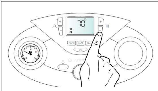
**Регулирование температуры воды в контуре ГВС****CLAS PREMIUM EVO**
